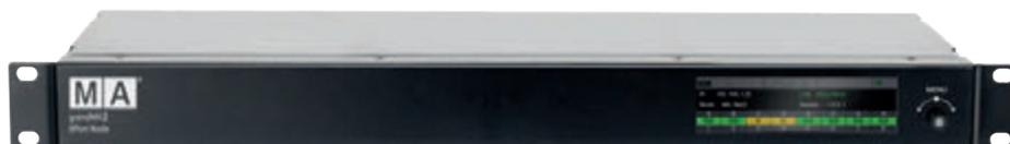
A grandMA3 8Port Node é o maior conversor Ethernet para DMX da MA Lighting. Projetado especificamente para converter 8 universos DMX de forma síncrona a partir de qualquer sessão grandMA3, de 19", 1RU é adequada para instalações fixas e em turnê.
