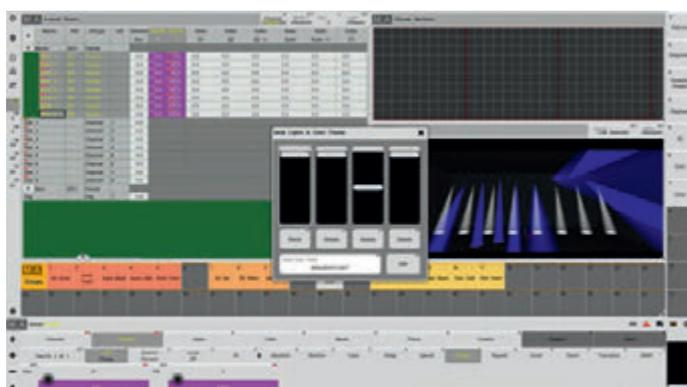
As opções de reprodução na grandMA3 permitem a máxima usabilidade de todas as sequências. Os usuários podem agora atribuir qualquer função a qualquer ação de um botão, fader ou encoder. Desde uma simples funcionalidade GO+ em um único botão, ao avanço rápido quando um codificador é girado no sentido horário e retrocedido quando girado no sentido anti-horário.
