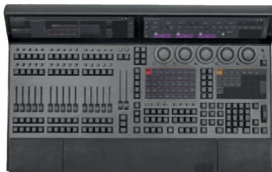
A grandMA3 Light Control Room (CRV) é fornecido sem o monitor wing. Projetado para uso em salas de controle onde as linhas de visão podem ser desafiadoras, a grandMA3 light possui 2 portas de monitor externo adicionais para facilitar a localização conveniente de telas de toque externas de terceiros sem comprometer a funcionalidade do console grandMA3 light.
